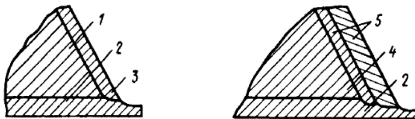
Рисунок 2. Схема выполнения предварительной наплавки кромок деталей из двухслойных сталей с плакирующим слоем, не содержащим ниобий:
